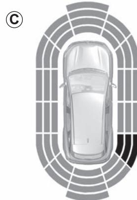
Glede na oddaljenost predmeta postajajo zvočni signali pogosteji s približevanjem ovir, dokler se ne spremeni v nepreklenjen pisk, ko je ovira oddaljena približno 20 cm ob straneh vozila in približno 30 cm spredaj ali zadaj. Na prikazovalniku **C** bo prikazano zeleno, oranžno (ali rumeno – odvisno od vozila) in rdeče območje.
