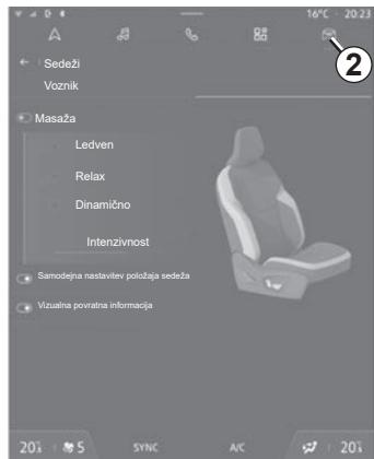
Pri vključenem kontaktu na zaslonu multimedejskega sistema izberite sistem »Vozilo« **7**, »Sedeži«, nato »Masaža«.
