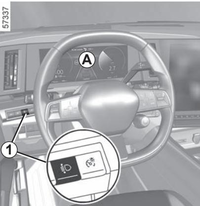
**Instrumentna plošča A:** zasveti ob odpiranju voznikovih vrat. Stikalo 1 pritisnite tolikokrat, da boste lahko nastavili svetlost.
