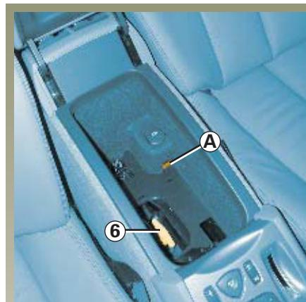
Sprostitev zavore z zasilno ročico (okvara akumulatorja ali nerazpoložljivost sistema)
