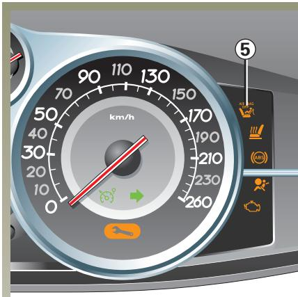
Po vključitvi kontakta **obvezno** preverite, ali je na instrumentni plošči ali na prikazovalniku armaturne plošče, odvisno od vozila, prižgana kontrolna lučka 5
