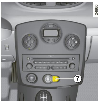
Za zaklepanje vozila z enim odprtим odpiralnim delom (prevoz tovora z odprtим prtljažnikom ...) ali ko se vozilo nahaja v območju z močnim elektromagnetnim sevanjem ali v primeru okvare ključa ali kartice RENAULT: pri izključenem kontaktu pritisnite na stikalo 7 za več kot pet sekund.
