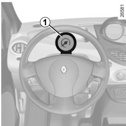
**Merilnik vrtljajev 1 (skala x 100) (pri nekaterih izvedenkah)**
