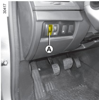
Pri vozilih z gumbom **A** lahko prilagajate višino svetlobnega snopa žarometov glede na obremenitev.
