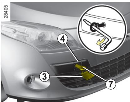
Za vleko morate obvezno uporabljati mesto za pritrditev vlečnega priključka na sprednjem delu vozila **4** in mesto za pritrditev vlečnega priključka na zadnjem delu vozila **5**.
