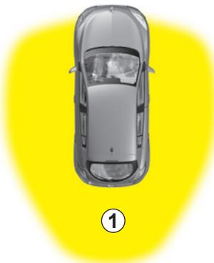
Zaklepanje je potrjeno z **dvakratnim utripom** varnostnih utripalk in zvočnim signalom.
