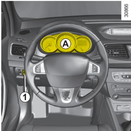
**Instrumentna plošča A:** osvetli se ob vključitvi kontakta. Jakost osvetlitve lahko nastavljate z gumbom 1.
