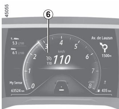
Opozorilna lučka 6 izgine z instrumentne plošče in s tem potrdi, da funkcija ni več aktivna.
