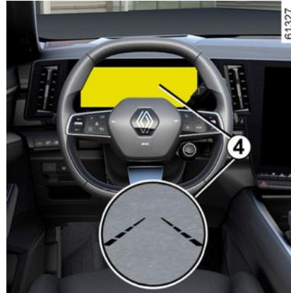
Ko se funkcija vklopi, se na instrumentni plošči prikažejo ter levi in desni črtni indikatorji 4.
