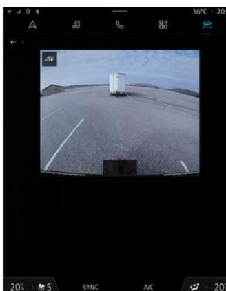
Če vozite naprej in imate priključeno prikolico, na zaslonu multimedejskega sistema **5** v sistemu "Vozilo" pritisnite gumb "Prikolica", da bo kamera **3** približno 30 sekund prenašala pogled na okolico na zadnjem delu vozila.
