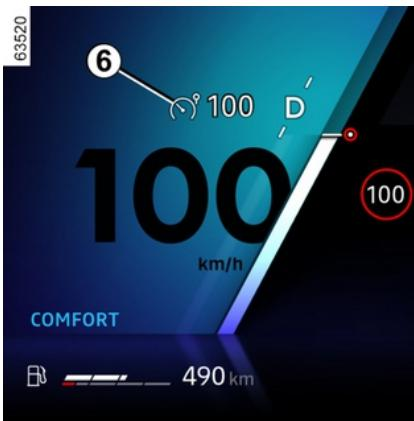
Prikaže se opozorilna lučka **6** sive barve. Sporočilo »Omejevalnik hitrosti je pripravljen: NASTAVITE za vklop« se prikaže na instrumentni plošči s črticami, kar pomeni, da je vključen omejevalnik hitrosti in da je treba shraniti omejeno hitrost.
