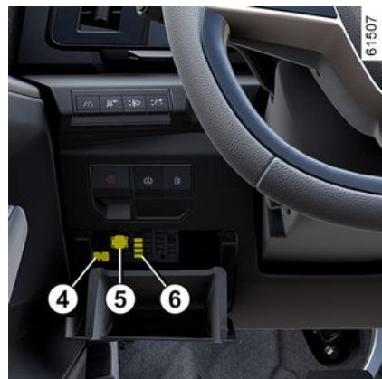
Odklopite varovalko z ročico **4** na plošči z varovalkami.
