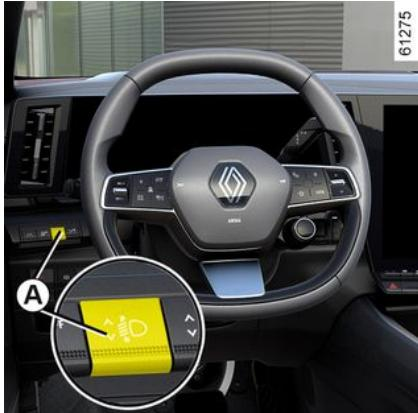
Glede na vozilo lahko s stikalom **A** nastavite višino snopa žarometov glede na obremenitev.
