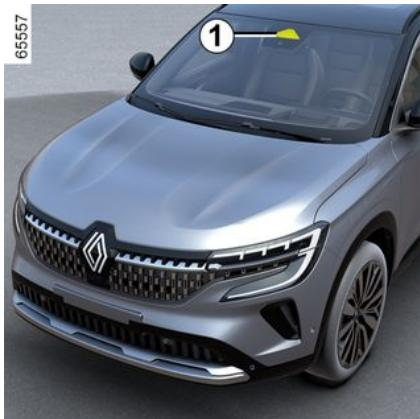
Funkcija na podlagi podatkov kamere **1** v krmilnem sistemu vozila sproži opozorilni svetilki, če vozilo prečka neprekinjeno ali prekinjeno črto ali če se približa robu ceste (pregrada, ograja, pločnik, nasip itd.), ne da bi pri tem nakanali smer s smernimi kazalci.
