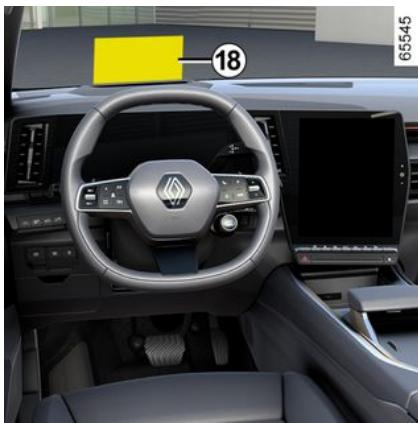
Prikazovalnik povzema informacije o vožnji in navigaciji z instrumentne plošče in zaslona multimedejskega sistema. Informacije se projicirajo na vetrobransko steklo.
