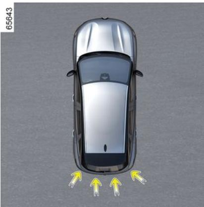
Poleg funkcije "pomoč pri parkiranju" → 270 in uporabe informacij iz štirih osrednjih senzorjev na zadnji strani vozila sistem zazna tudi nepremične ovire za vozilom. Če obstaja velika nevarnost trka, sistem samodejno vklopi zaviranje vozila.
