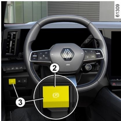
Za ročno zategnите samodejne parkirne zavore (postanek pred semaforjem, ko vozilo miruje z delujočim motorjem itd.): dvignite in nato spustite stikalo **3**. Zavora se samodejno sprostijo takoj, ko speljete.
