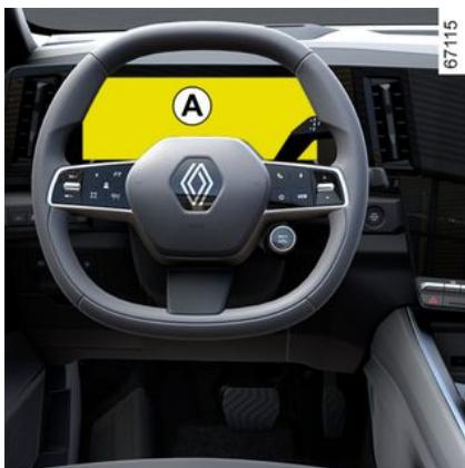
Instrumentna plošča A: ta zasveti, ko se odprejo voznikova vrata.
