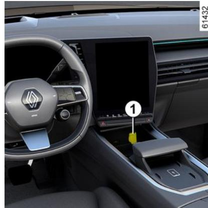
Uporabite lahko vtičnice za dodatno opremo **1** za priključitev dodatne opreme.
