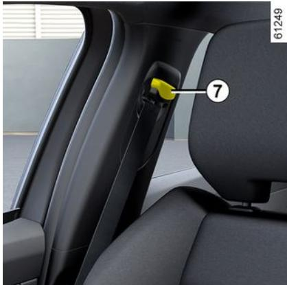
Z gumbom **7** lahko nastavite višino pritrdišča ramenskega dela pasu, tako da je ta pravilno speljan, kot je predhodno opisano. Pritisnite gumb **7** in zvišajte ali znižajte višino pritrdišča pasu. Po opravljeni nastavitvi preverite ali je pritrdišče dobro učvrščeno.
