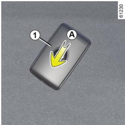
Ko se na instrumentni plošči prikaže sporočilo "Slaba baterija kartice", zamenjajte baterijo kartice:
