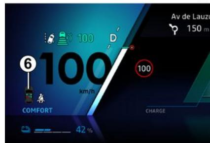
Ko so vrata zaprta, se na instrumentni plošči ob vklopu kontakta za približno 60 sekund prikaže slika **6**. To voznika vedno obvesti o stanju pripenjanja vsakega od sprednjih varnostnih pasov:
