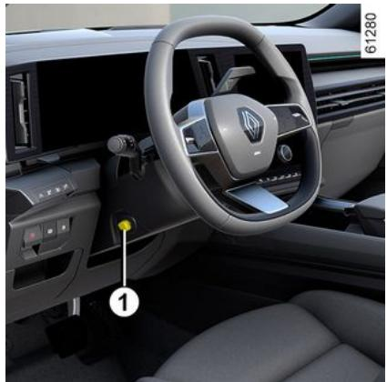
Spustite ročico **1** in nastavite volan v želeni položaj.
