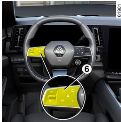
Za prilagoditev nastavitev omejevalnika hitrosti, regulatorja ali prilagodljivega regulatorja hitrosti zaznani omejitvi hitrosti pritisnite stikalo 6.
