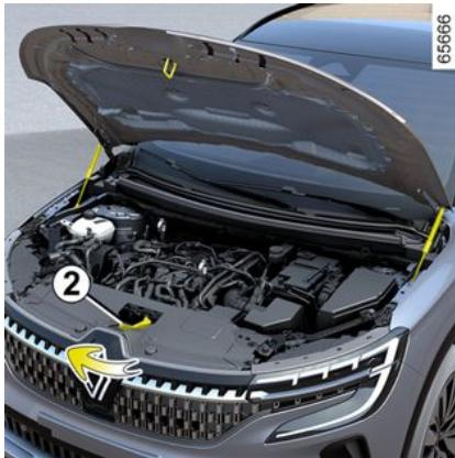
Za sprostitev potisnite ročico **2** v levo in istočasno dvignite pokrov motorja.
