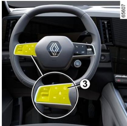
Funkcija prilagodljivega regulatorja hitrosti Stop and Go se izklopi, ko pritisnete stikalo **3**.
