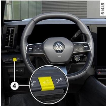
Če želite odpreti vrata prtljažnika, pritisnite in držite stikalo **4**, dokler ne zaslišite zvočnega signala, nato spustite stikalo.
