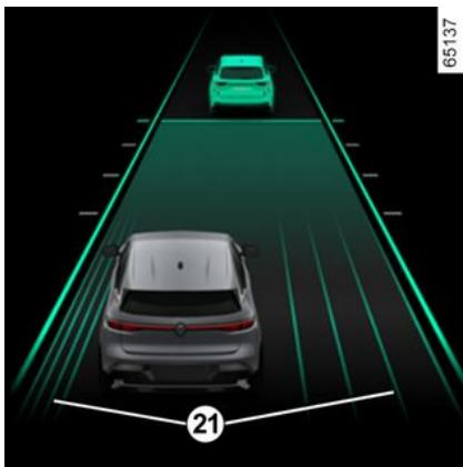
Za aktiviranje položaja na vozнем pasu mora biti funkcija "poravnave vožnje na sredini vozneg pasu" v prilagoditvenem načinu, na instrumentni plošči mora svetiti zelena opozorilna lučka **22** in vozilo mora voziti s hitrostjo manj kot 50 km/h.
