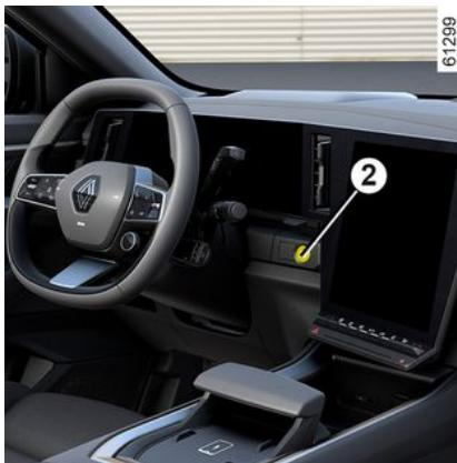
Če pametnega telefona ni več v potniškem prostoru, ko poskušate ugasniti motor, se na instrumentni plošči prikaže sporočilo: pritisnite in več kot dve sekundi držite gumb za zagon/ustavitev motorja **2**.
