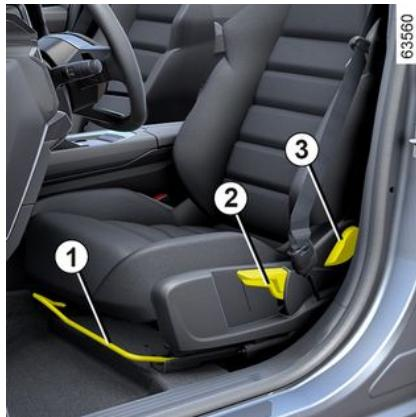
Dvignite ročico **1**, da jo odklenete. V želenem položaju spustite ročico in se prepričajte, da se je mehanizem pravilno zaskočil.
