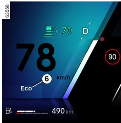
Na instrumentni plošči se prikaže kontrolna lučka »ECO« **6**, ki potrdi vklop. Za to, do konca pohodite pedal plina. Način ECO se ponovno vklopi, ko odmaknete nogu s pedal za plin.
