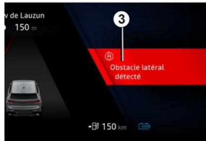
Ko je zaznan predmet zelo blizu, se zasliši zvočni signal in na instrumentni plošči se prikaže opozorilno sporočilo "Bočna ovira zaznana" **3**.
