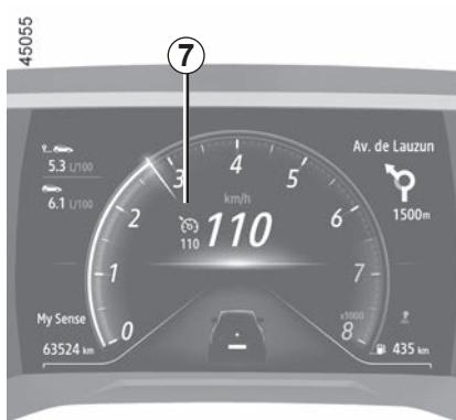
Opozorilna lučka **7** izgine z instrumentne plošče in s tem potrdi, da funkcija ni več aktivna.
