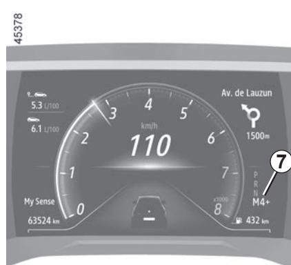
**Opomba:** v samodejnji način delovanja se vrnete z daljšim pritiskom desne ročice. Na instrumentni plošči se prikaže samodejni način **D**.
