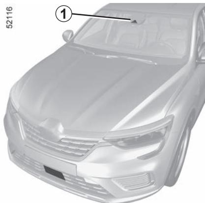
Sistem zazna znake za omejitev hitrosti na robu ceste in na instrumentni plošči prikaže predpisano omejitev hitrosti.
