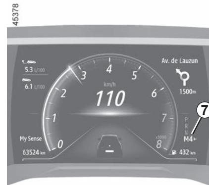
**Opomba:** v samodejni način delovanja se vrnete z daljšim pritiskom desne ročice. Na instrumentni plošči se prikaže samodejni način **D**.
