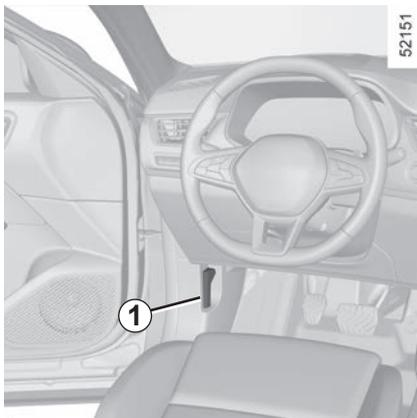
Za odpiranje pokrova motornega prostora, odprite vrata in potegnite ročico **1** na levi strani armaturne plošče.
