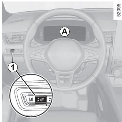
Instrumentna plošča **A** ali **B**: zasveti, ko vklopite kontakt. Pritisnite ali dvignite stikalo **1** tolikokrat, kot je potrebno za nastavitve jakosti.
