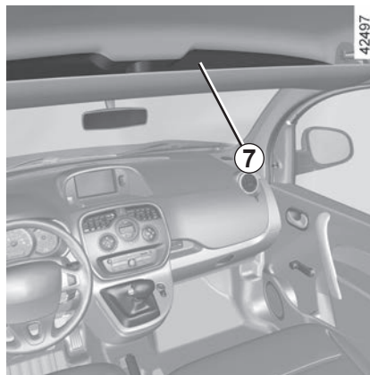
Polica pod stropom kabine spredaj 7
