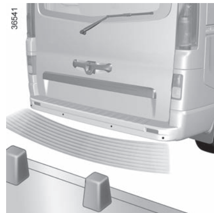
Opomba: ultrazvočni senzorji ne smejo biti prekriti (z umazanijo, blatom, snegom itd.).
