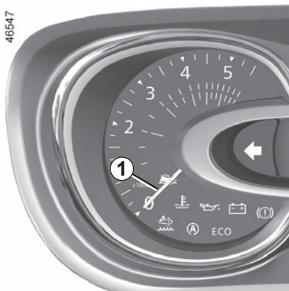
Merilnik vrtljajev 1 (skala x 1000)
