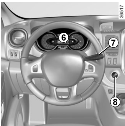
Instrumentna plošča 6 v miljah (možnost preklopa na km/h)
